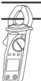
Figur 6: Använd klämman för mätningar av likström
