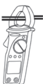
Figur 6: Använd klämman för mätningar av likström
