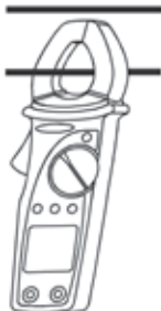
Fig. 6 : Utilisation de la pince pour les mesures de courants continus
