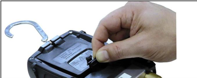
1. Relever le dispositif d'accrochage, détacher le clip et retirer le couvercle du compartiment à piles.
