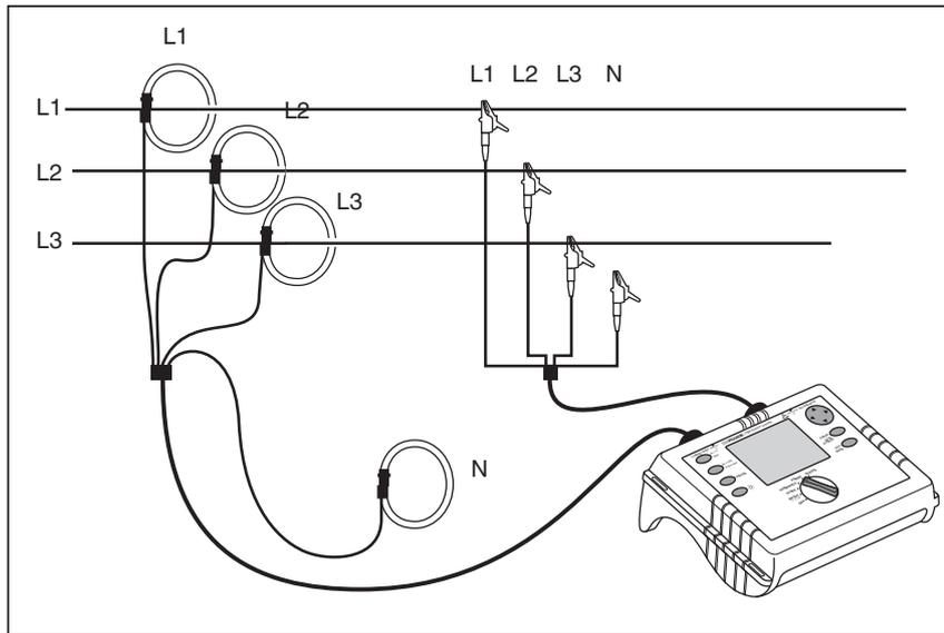
Abbildung 10. Dreiphasen-Delta-Schaltungsanschlüsse  $\Delta$  - Blondel (Aron, 3-Elemente-Delta)
