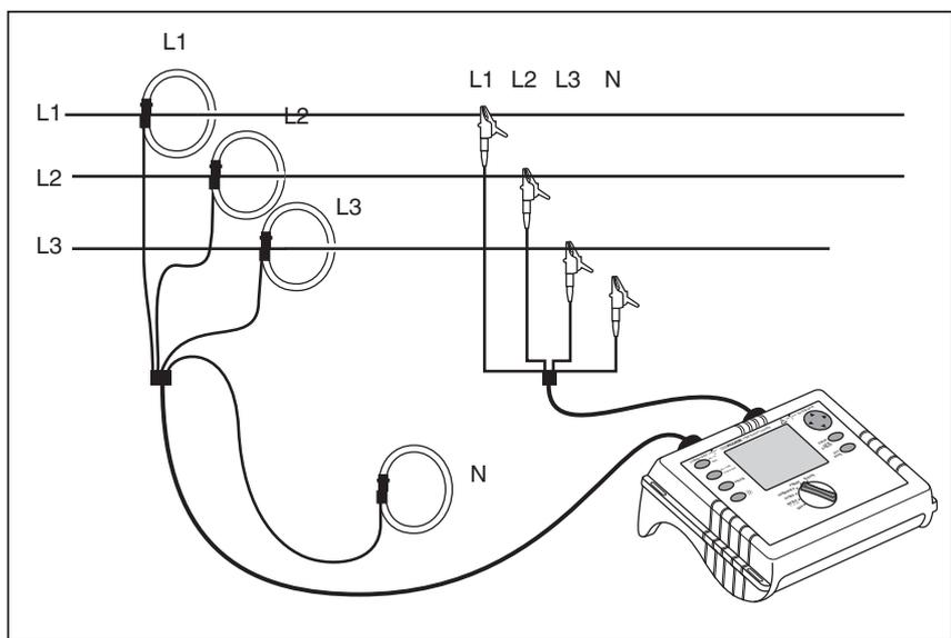
Figura 10. Delta trifásico Δ Conexiones Blondel (Aron, Delta de tres elementos) Conexiones Blondel (Aron, Delta de tres elementos)" \f f
