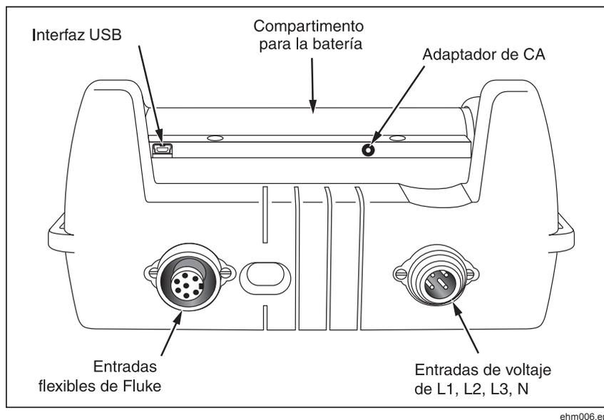
Figura 3. Conectores de Power Logger
