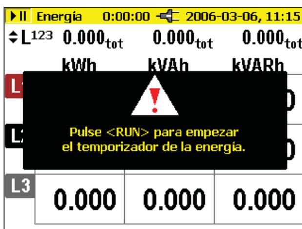
El tiempo de acumulación se indica en la parte superior de la pantalla de medición.
