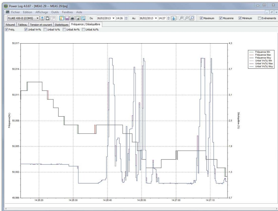
Figure 10. Fréquence affichée dans le diagramme temporel Fréquence/Déséquilibre
