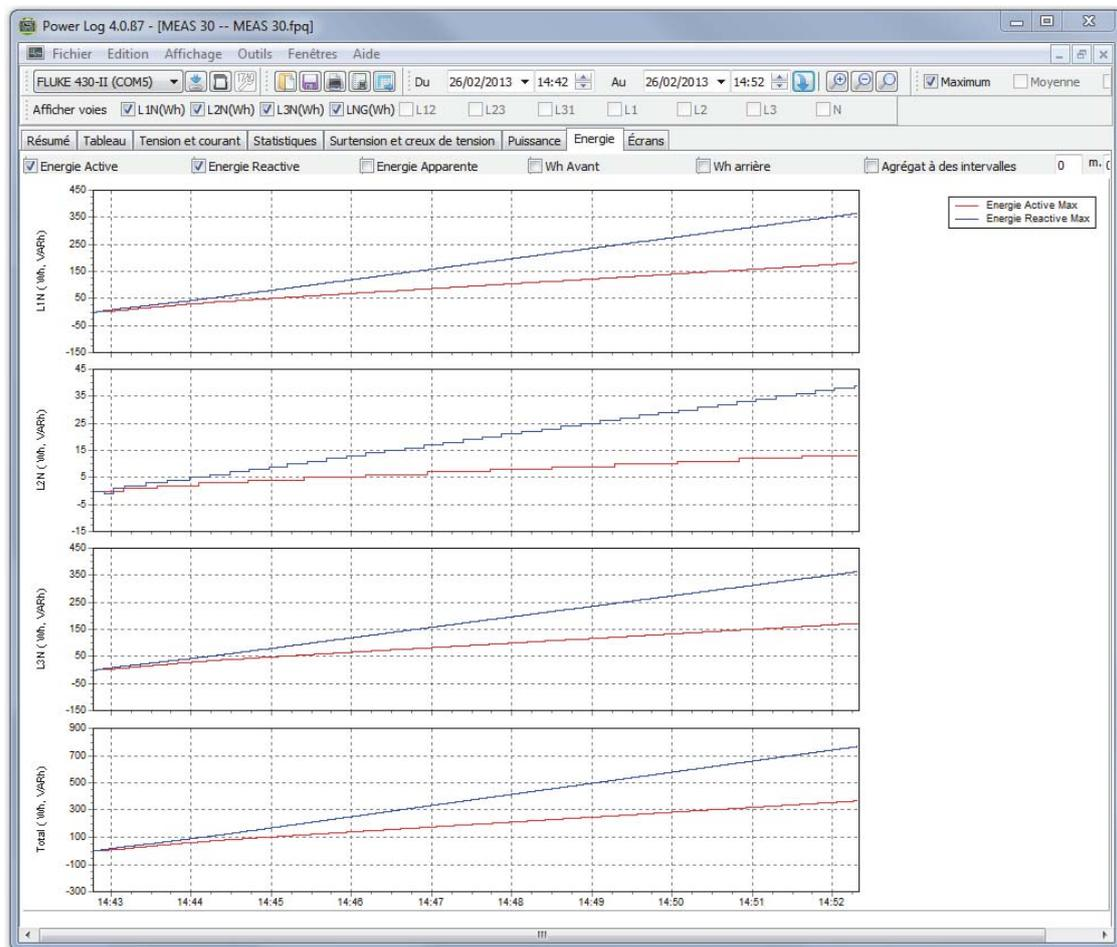
Figure 15. Diagramme temporel Energie pour la période sélectionnée
