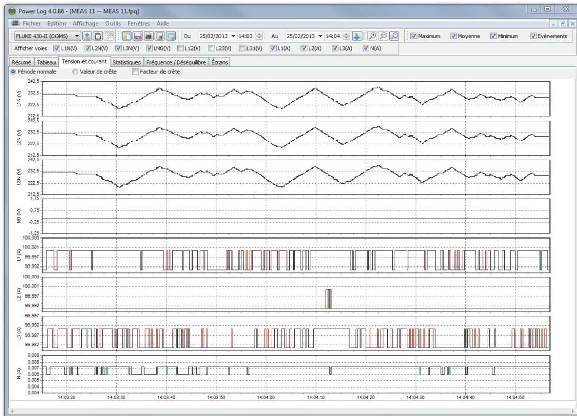
Figure 5. Voies sélectionnées visibles dans le diagramme temporel Courant et Tension
