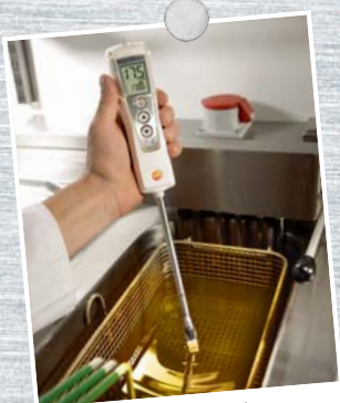
Überprüfung der Frittierölqualität in einer Fritteuse
