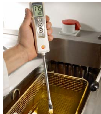
Abb. 12: Messung des TPM-Wertes an Frittieröl mit dem testo 270
