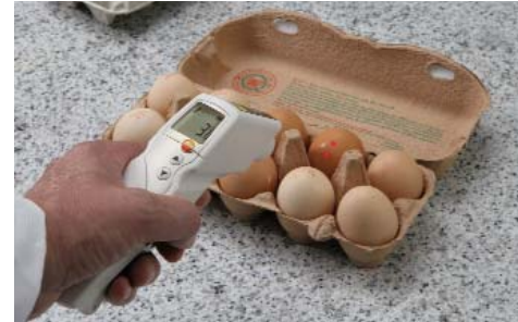
Abb. 5: Infrarot-Messung der Oberflächentemperatur an Nahrungsmitteln
