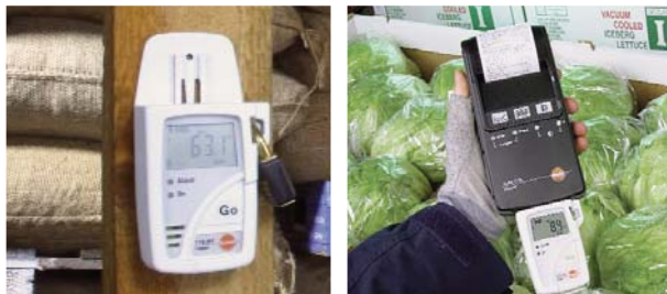
Abb. 7: Einsatz von Datenloggern
