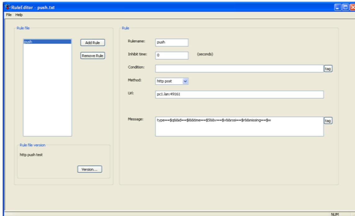
Le Rule-Editor (c'est-à-dire „l'éditeur de règle“) est une aide à l'établissement d'un fichier „Rule“ qui est utilisé par la BS1000 pour piloter la fonction Messenger intégrée. La fonction Messenger permet le démarrage d'une ou de plusieurs actions en raison d'une valeur de mesure reçue si un nombre de règles établies auparavant a été rempli. Les actions possibles consistent en l'envoi d'un mail, d'une requête HTTP (HTTP request) et l'activation du buzzer intégré.
