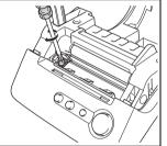
Setzen Sie die DK-Rolle wieder ein und schließen Sie das DK-Rollenfach.
