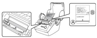
Nachdem das Reinigungsblatt in den Schlitz eingeführt wurde, drücken Sie den Transportrollen- Hebel wieder nach unten und ziehen Sie dann den Aufkleber (B) vom Reinigungsblatt ab.
