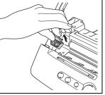
Setzen Sie die Schneideeinheit in den Drucker ein.
