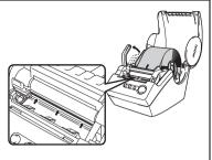
Drücken Sie den Hebel nach unten und schließen Sie das DK-Rollenfach
