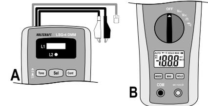
Le boîtier du DMM LSG-4 comprend deux parties qui fonctionnent de façon autonome. Le détecteur de câbles (générateur de signaux) "A" dispose d'une séparation de protection par rapport au multimètre (DMM) "B". Les deux parties de l'appareil fonctionnent indépendamment l'une de l'autre.
